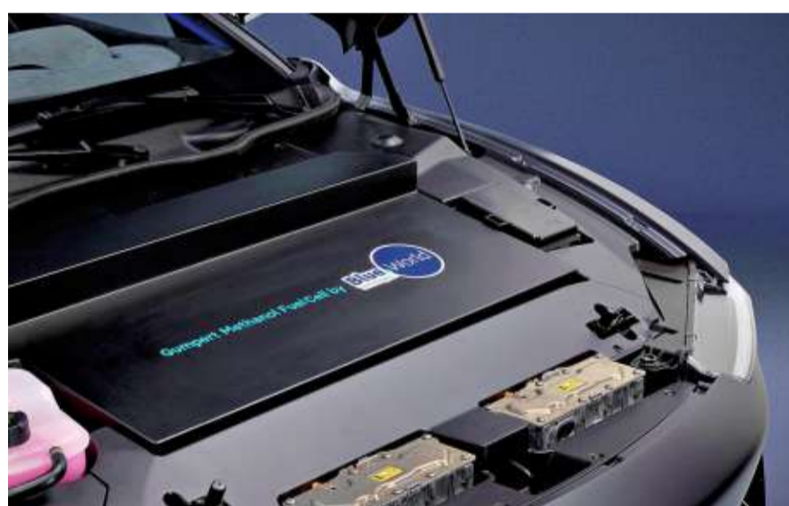
In Roland Gumperts Supersportwagen „Nathalie“ erzeugt eine Brennstoffzelle Strom.
