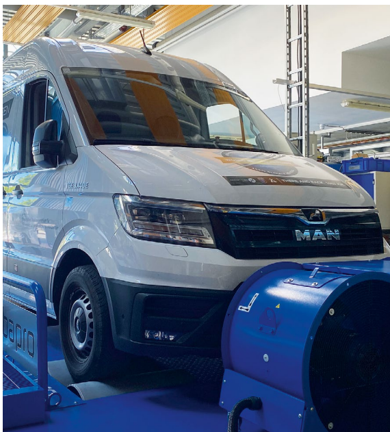
BILD 5 RMFC-Transporter-Prototyp auf dem Rollenprüfstand (© Gumpert)
